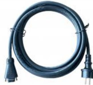
Das Plug-and-Play-Kabel ist für den Fall konzipiert, dass eine PV-Anlage nur über einen Mikrowechselrichter verfügt. Es besteht aus dem HMS-Feldstecker, dem AC-Kabel und dem Schuko Stecker. Der HMS-Feldstecker wird an den Mikrowechselrichter angeschlossen und der Stecker gemäß den örtlichen Vorschriften an die Haushaltssteckdose angeschlossen. Dieses einfache Plug-and-Play-Design ermöglicht es Benutzern, das einzelne Mikrowechselrichtersystem einfach und schnell an das Netz anzuschließen.
